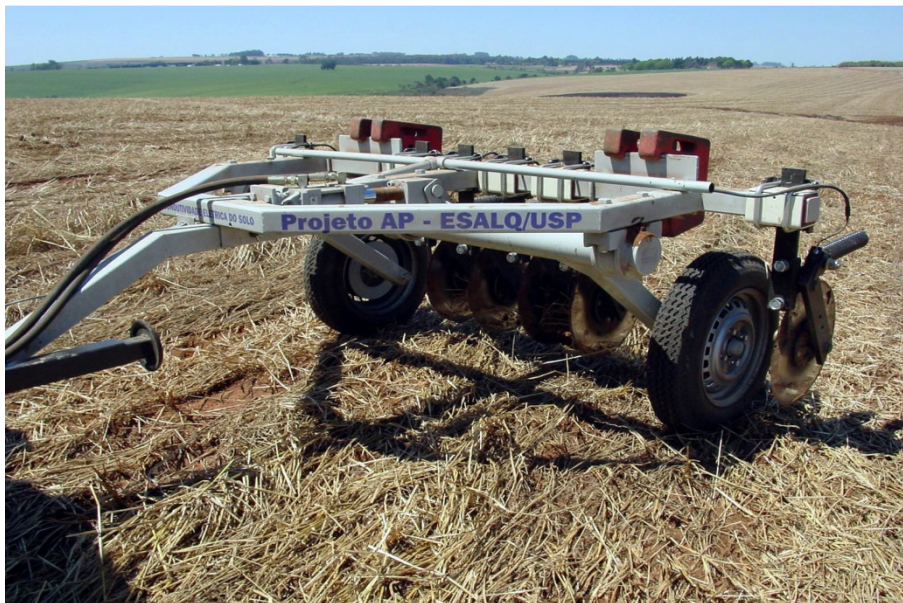
Figura 2 – Equipamento comercial “Veris”: possui sensores de condutividade elétrica do solo.
